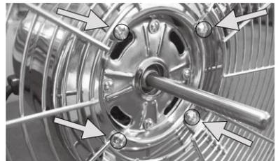
7. Richten Sie den Lüfterflügel (2) mit dem flachen Teil auf der Motorwelle (6) aus und befestigen Sie ihn mit der Lüfterflügelschraube (5), bis er fest sitzt.
