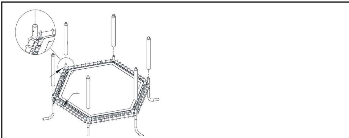
5. Bitte befestigen Sie das Netz von oben nach unten am Hauptgestell mit der Befestigungsschnalle des Netzes am Balkkopf und binden Sie das darunter liegende Gummiband an das darunter liegende Rohr.
