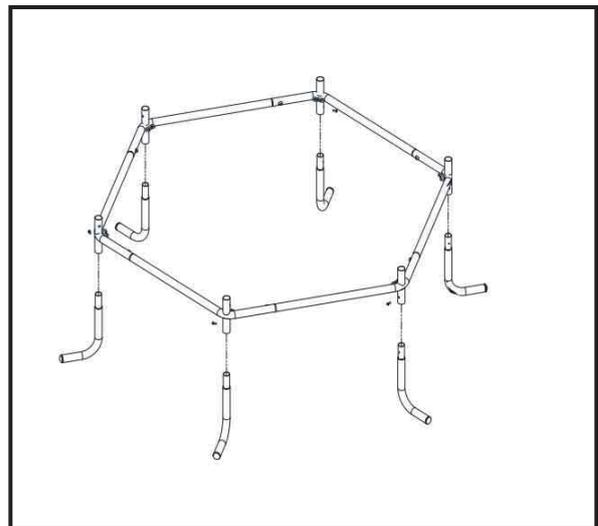
2. Setzen Sie das "L"-Beinrohr der Reihe nach in das Hauptgestell ein und ziehen Sie die Schrauben mit einem Werkzeug fest.
