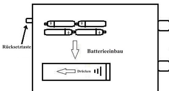
**Schritt 1:** Bei geöffneter Tür das Batteriefach öffnen und die Batterien einlegen.
