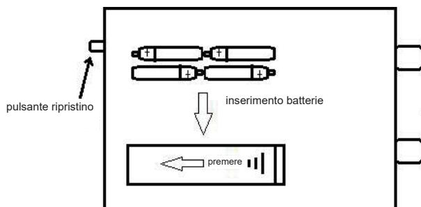
**Passaggio 1:** quando il portello è aperto, aprire il vano batterie, ed inserirle.
