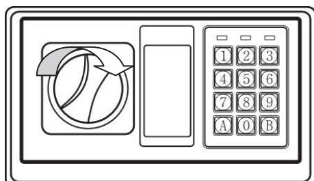
**Schritt 1:** Die Abdeckung abnehmen, dann den Notschlüssel einschieben und nach links drehen.
