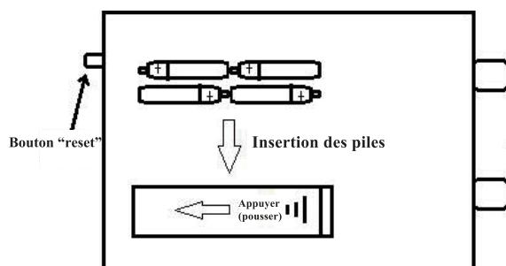
**Étape 1:** Une fois la porte ouverte, ouvrir le compartiment des piles et introduire les piles.
