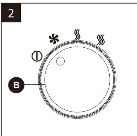
3. Regolare la temperatura ruotando la manopola del termostato sul pannello di controllo (B).
