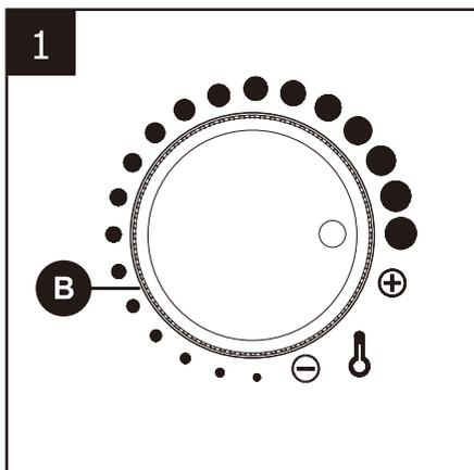
2. Ruotare la manopola delle funzioni sul pannello di controllo (B) per scegliere la modalità desiderata.
