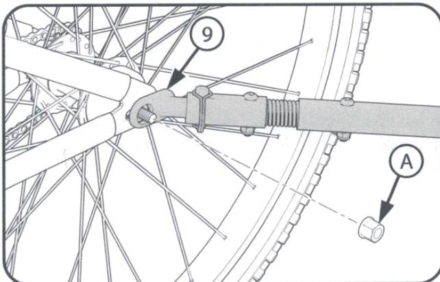
**⚠️ WARNUNG:** Vergewissern Sie sich, dass das Gewinde vollständig eingreift und das Gewinde über das Ende der Mutter hinaus sichtbar ist.
