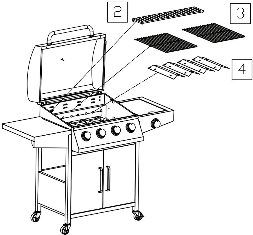
13. Warmhalterost (2), Kochroste (3) und Wärmezelte (4) werden in den Körper eingesetzt.
