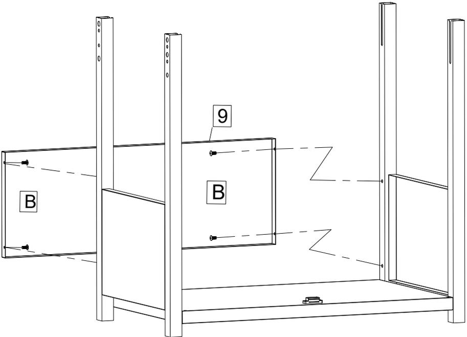
2. Befestigen Sie die hintere Ablage (9) mit vier M5-Schrauben (B) an den Rahmen.
