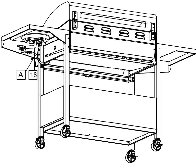
9-1. Der Seitenbrenner (18) wird mit zwei M4-Schrauben (A) an der Seitenbrennerablage befestigt. Führen Sie den Schlauch in den Ventilanschluss ein.
