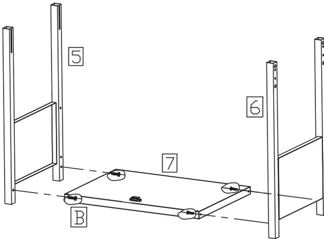
1. Befestigen Sie den linken und rechten Rahmen (5 & 6) mit vier M5-Schrauben (B) an der unteren Ablage (7).
