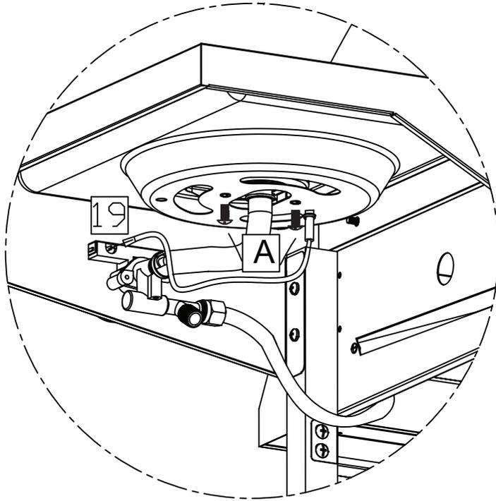
9-2. Ein Ende der Zündung (19) wird mit einer M4-Schraube (A) und einer M4-Mutter (D) an der seitlichen Brennerablage befestigt. Befestigen Sie das andere Ende am Ventilanschluss.
