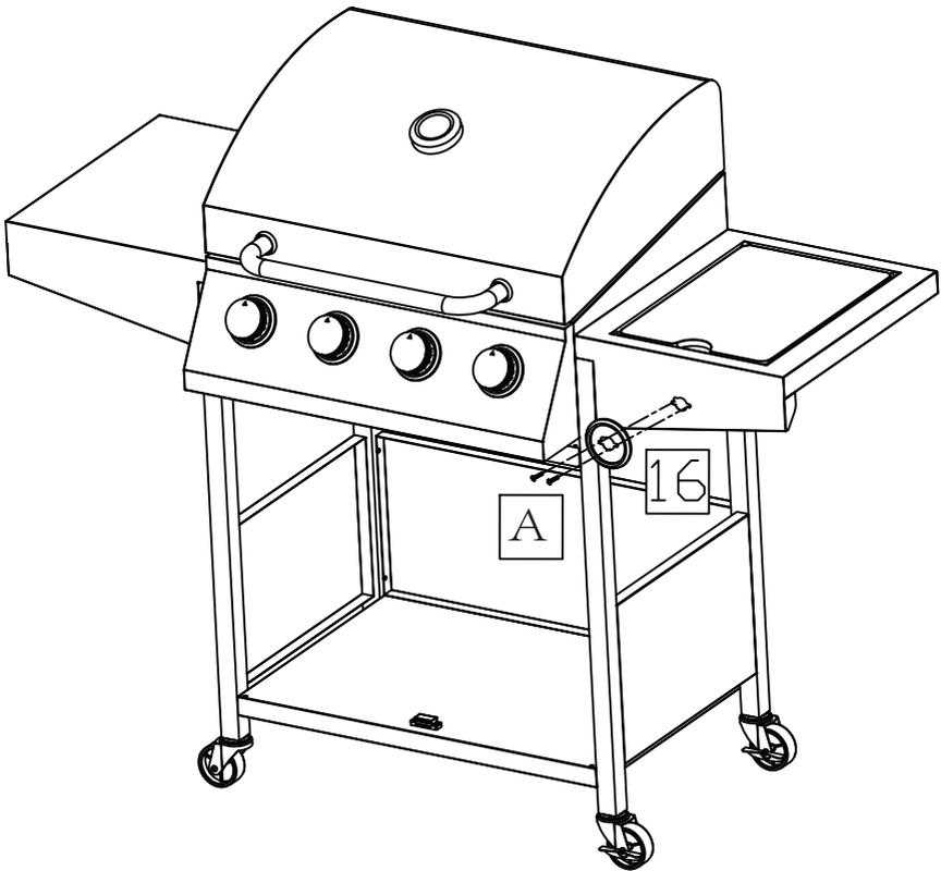
8. Die Basis des Seitenbrenner-Drehschalters (16), die Frontplatte des Seitenbrenners und das Seitenbrennerventil (in der Frontplatte der Ablage) werden mit zwei M4-Senkkopfschrauben (A) montiert.
