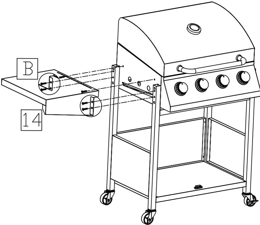
6. Befestigen Sie die linke Seitenablage (14) mit sechs M5-Schrauben (B) am Körper.
