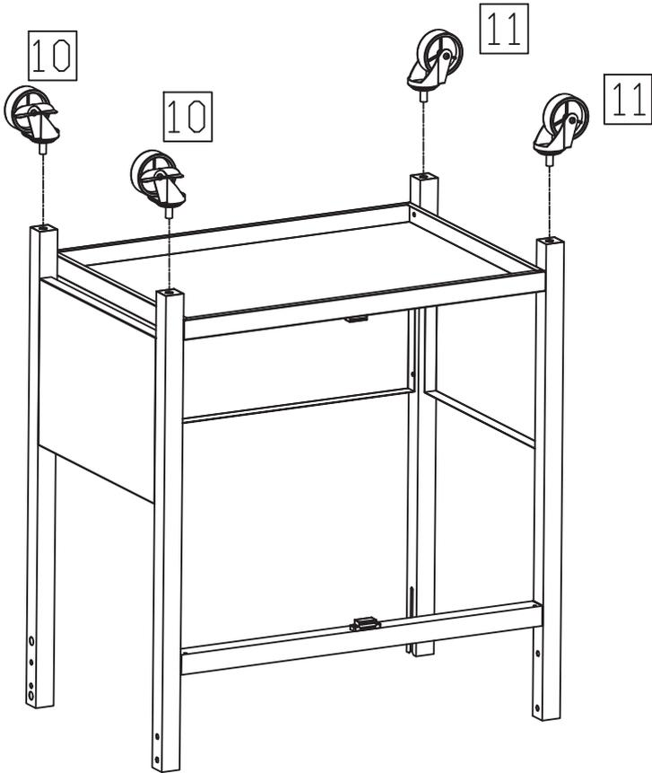
4. Befestigen Sie die vier Räder (10 & 11) an der Unterseite der Rahmenbeine.
