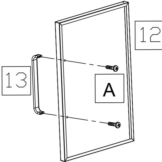
11. Befestigen Sie die Griffe (13) mit vier M4-Schrauben (A) an den Fronttüren (12).
