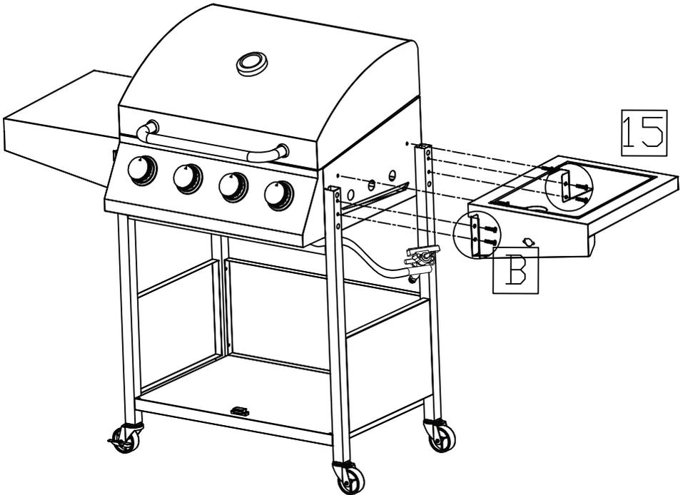
7. Befestigen Sie die rechte Seitenablage (14) mit sechs M5-Schrauben (B) am Körper.
