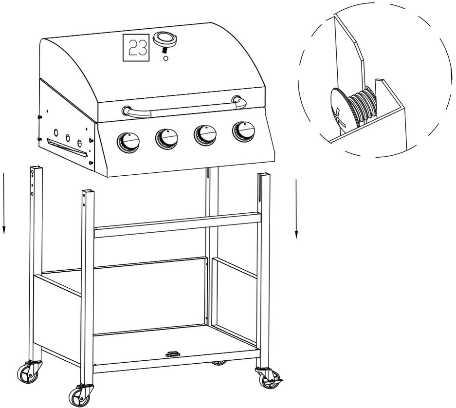
5. Setzen Sie den Körper (1) mit acht M5-Schrauben in den Rahmen ein (siehe Abbildung oben). Ziehen Sie die Schrauben fest, nachdem der Körper in Position ist. HINWEIS: Vergewissern Sie sich, dass die acht Schrauben locker sind, bevor Sie es in die Position schieben.
