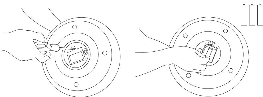
1 Desenrosca la tapa del compartimento de pilas con un destornillador.
