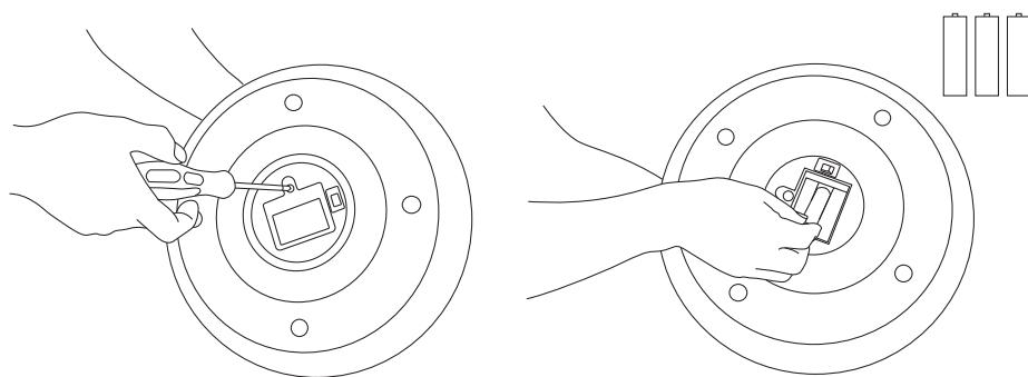
**1** Svitare il coperchio del vano batteria con un cacciavite.
