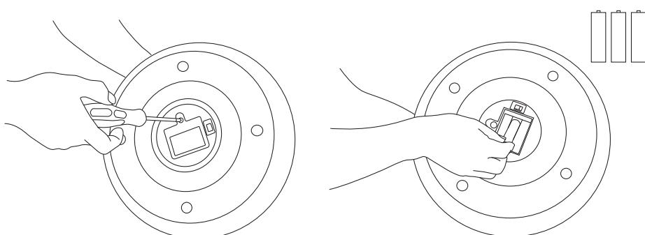
1 Schrauben Sie den Batteriefachdeckel mit einem Schraubenzieher ab.
