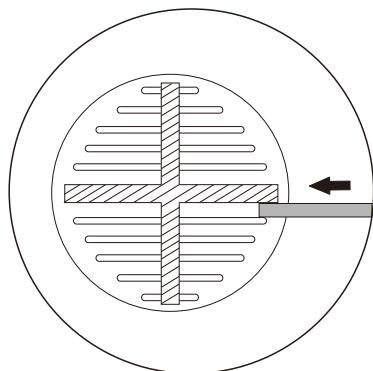
**DE** Beim Anbringen der Tür setzen Sie den Eisendraht an der Ecke entlang der inneren Riffel des Sektors eines Verbindungsstücks ein und der Eisendraht sollte "ganz unten" im Steckschlitz sitzen.
